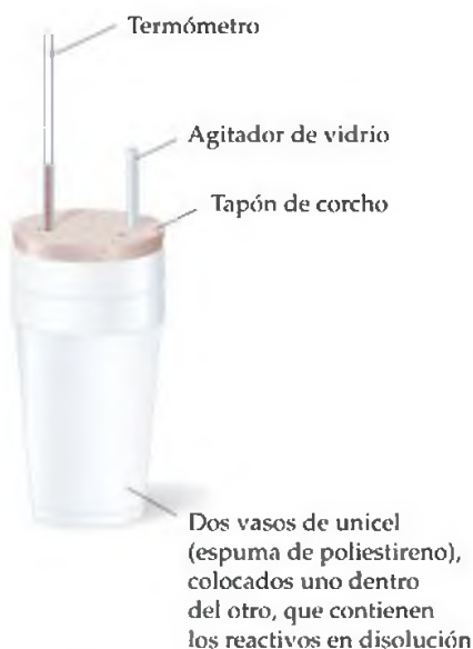
▲ Figura 5.17 Calorímetro del tipo de vasos de café. Aparato sencillo que se utiliza para medir el calor que acompaña a las reacciones a presión constante.
